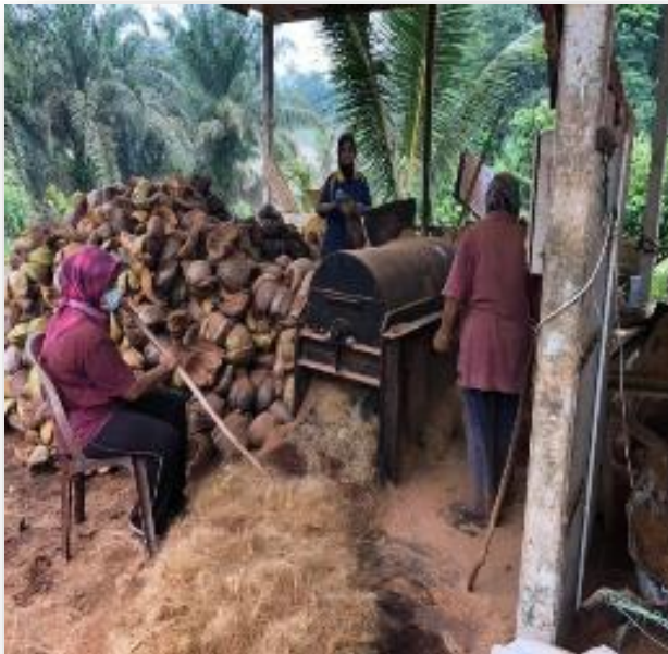
Rajah 7.2. Mesin pengestrak cocopeat dan jerami sabut kelapa
